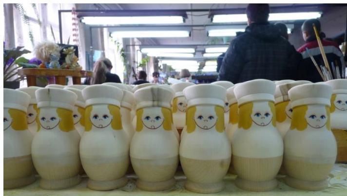
Заготовки матрешек грунтуют раствором крахмала.
