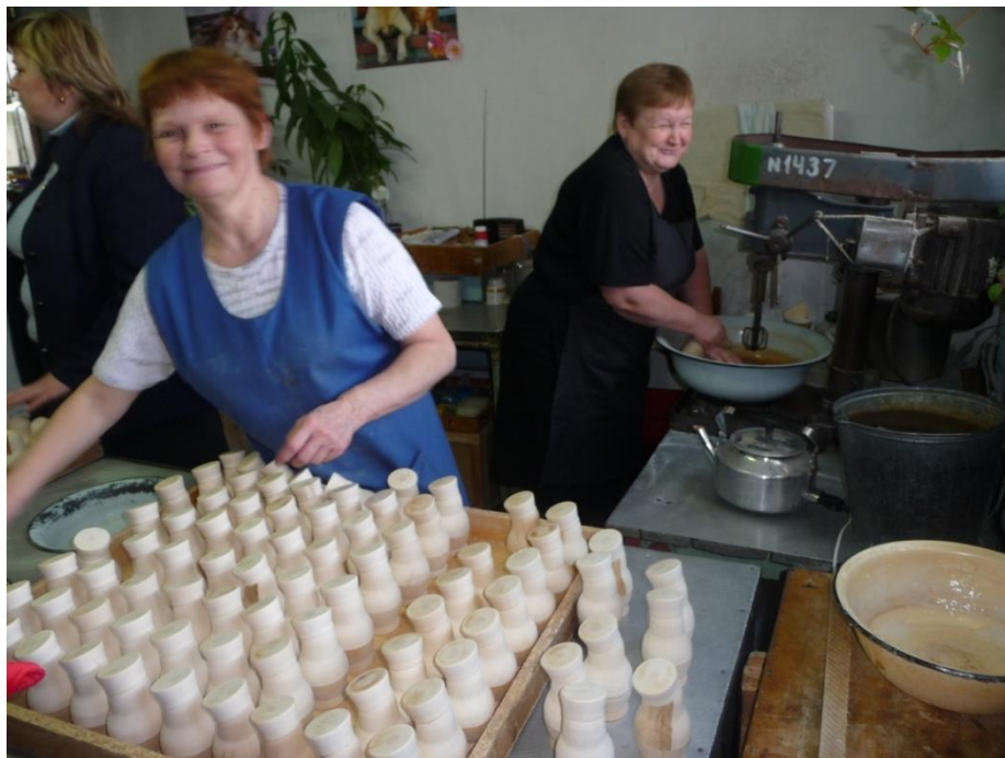
Заготовки матрешек грунтуют раствором крахмала.
