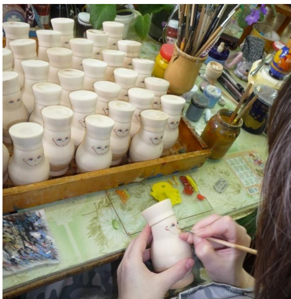
Заготовки матрешек грунтуют раствором крахмала.
